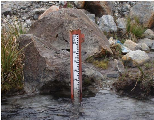
Figura 52. Mira limnimétrica. Fuente: (IDEAM & INVEMAR, 2021)
