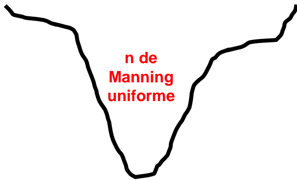
Figura 6.45 – Definición de rugosidades para una zona en cada abscisa: esquema (izquierda) y ventana del programa MIKE11 (derecha)
