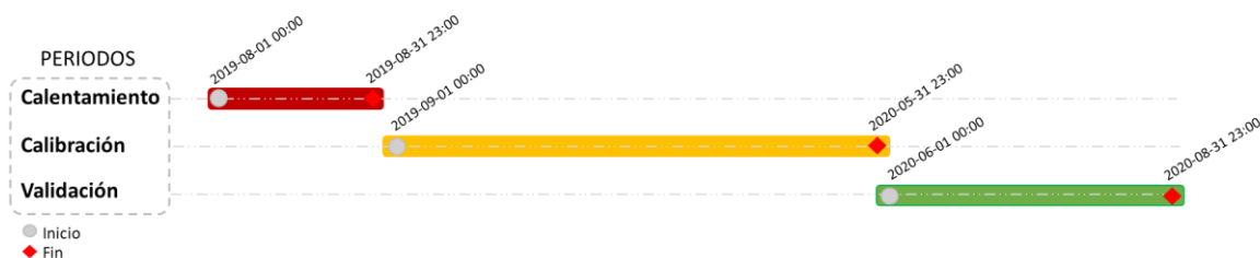
Figura 5.5 – Definición de los periodos de calentamiento, calibración y validación para los ejercicios de modelación hidrológica nivel horario (SZH Opón)
