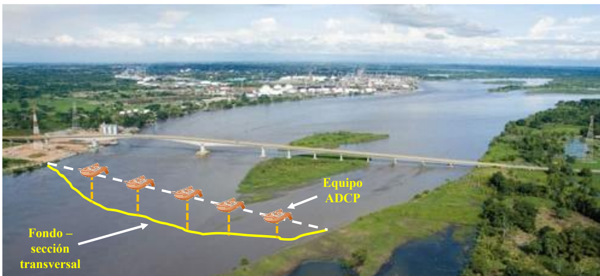
Figura 4.6 – Esquema de las mediciones realizadas en cada sección transversal
