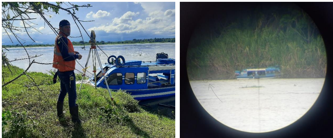
Figura 4.4 – Mediciones de cota de las secciones a partir de los puntos de topografía
