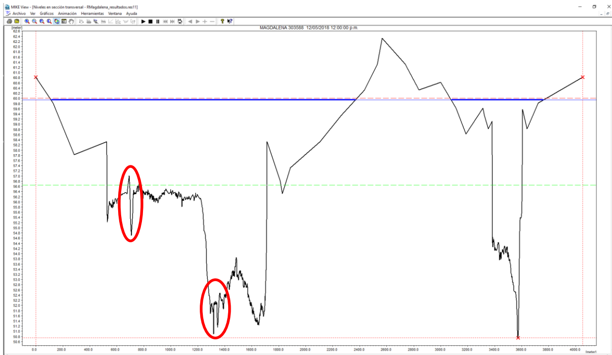
Figura 3.43 – Irregularidades en las secciones transversales del modelo hidráulico
