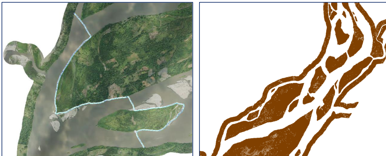
Figura 4.21 – Verificación de la batimetría (parte izquierda) y corte de nube de puntos LiDAR clasificada (parte derecha). (Fuente: INCIGE)
