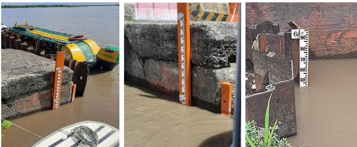
Figura 4.7 – Mediciones de las miras en las estaciones limnigráficas
