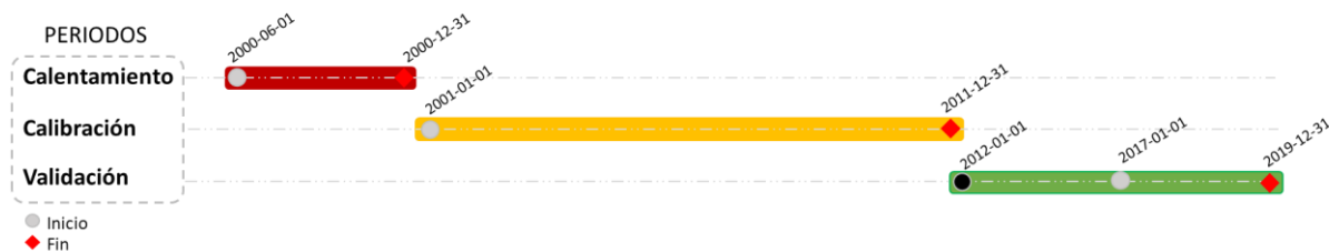
Figura 5.4 – Definición de los periodos de calentamiento, calibración y validación para los ejercicios de modelación hidrológica nivel diario (SZH Opón y Sogamoso)
