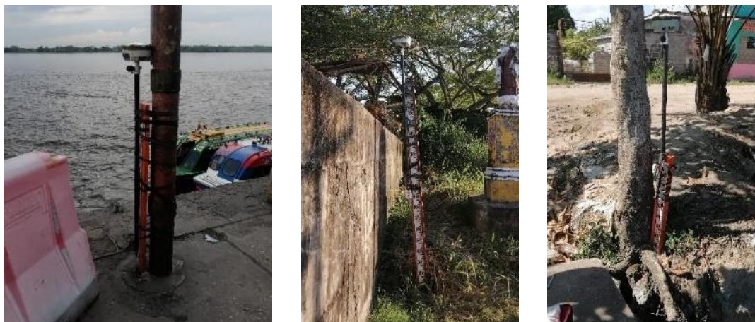
Figura 4.14 – Fotografías de las mediciones en las miras de las estaciones de Barrancabermeja (izquierda), Puerto Wilches (centro) y San Pablo (derecha)
