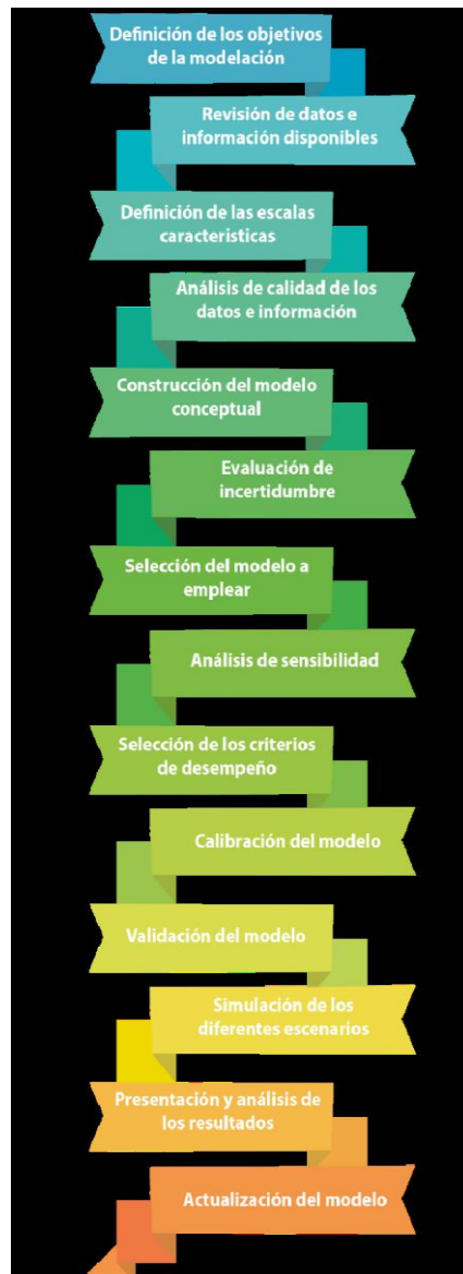
Figura 2.4 Etapas de la modelación hidrológica. Fuente: Protocolo de modelación hidrológica e hidráulica. IDEAM (2018)
