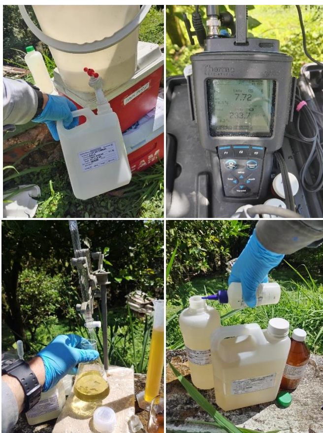
Figura 12. Llenado de recipientes, medición de variables In Situ, medición de oxígeno disuelto por titulación y preservación de muestras en estación Puente Nacional
