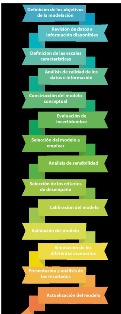
Figura 2.4 Etapas de la modelación hidrológica. Fuente: Protocolo de modelación hidrológica e hidráulica. IDEAM (2018)
